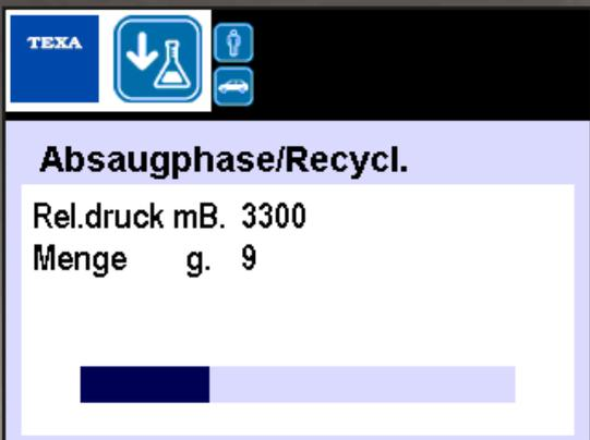
Während des Absaugens des Kältemittels aus der Anlage zeigt das Display die Menge des abgesaugten Kältemittels und den Druck der Anlage.
